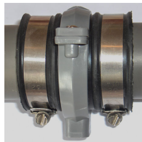
Figure 5 : Système de fixation du tube principal (1) sur le pied d'appareil photographique.
