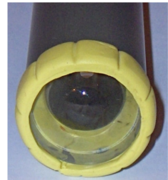
f) Oculaire divergent collé directement contre le tube secondaire (7b) avec de la patafix
